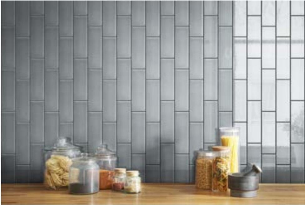
Aplicación tipo ladrillo vertical con desplazamiento al 50%
