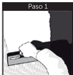
Paso 1 Aplicar adhesivo a la pared Apply mortar or tile adhesive to wall Appliquer l'adhésif de tuile sur le mur Aplique o adesivo na parede
